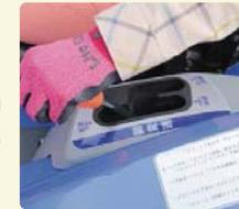
速度の目安は、1~2km/hです。変速レバーの位置は、車速表を確認してください。
