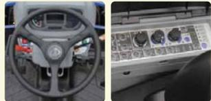
圧力水で洗車する際は、メーターパネルやハンドル回り、操作スイッチ回りなどの電気部品にはかけないでください。
