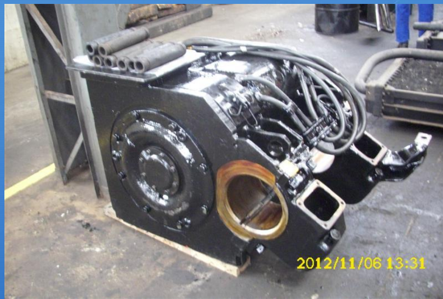
Foto nº 5: Exemplo de MT (loco GM G12 da Ferroeste)
