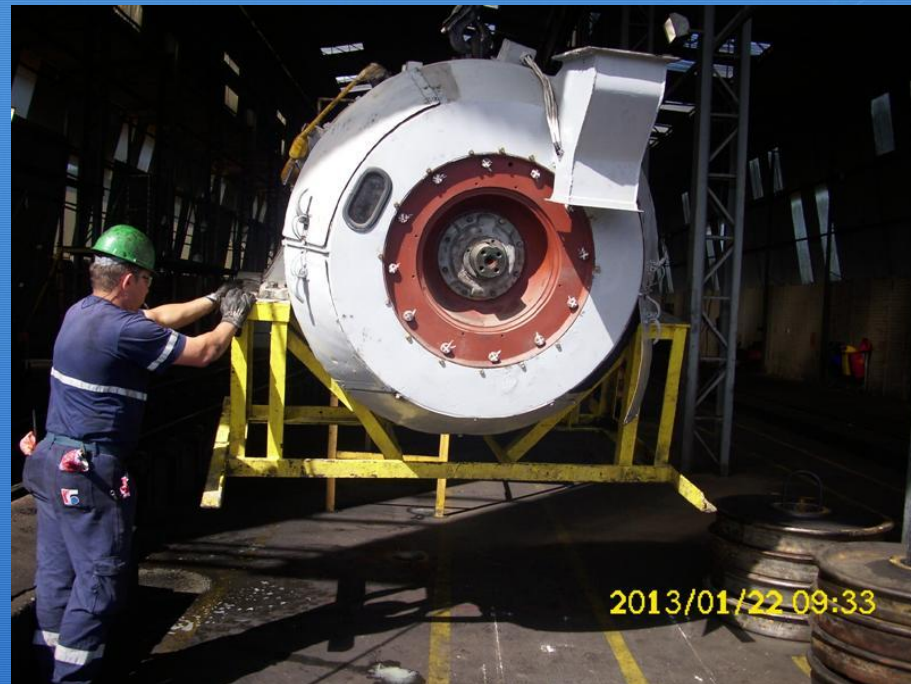
Foto nº 4: Exemplo de GP (loco GM G12 da Ferroeste)
