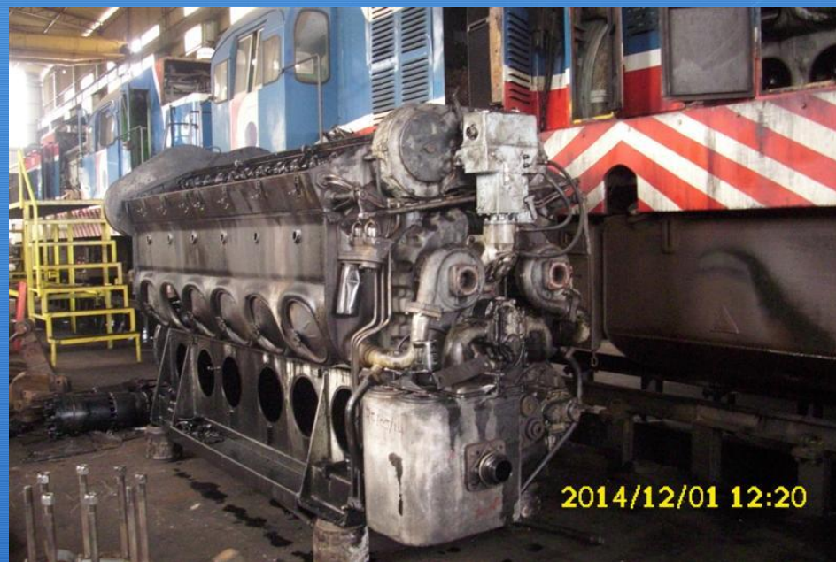
Foto nº 3: Exemplo de MD (loco GM G12 da Ferroeste)
