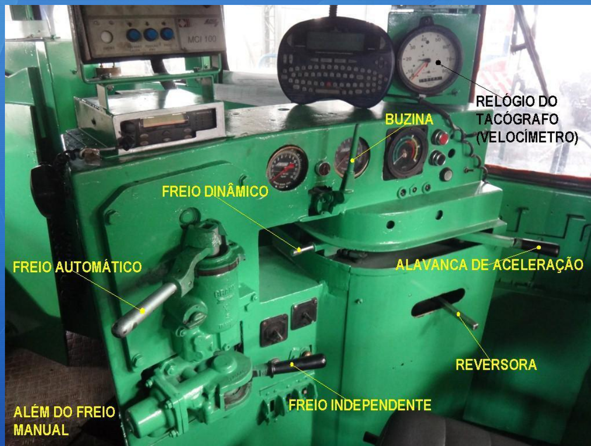
Foto nº 7: O controlador mestre de uma locomotiva MX620 da Ferroeste
