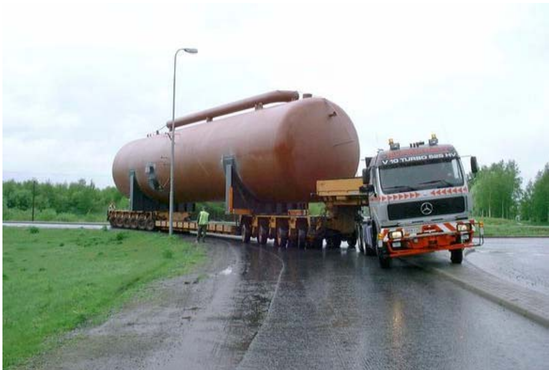
Kuva 5.22 Liian lähelle ajoradan reunaa sijoitettu valaisinpylväs vaikeuttaa kuljetuksen kääntymistä (Nurminen Heavy Oy).
