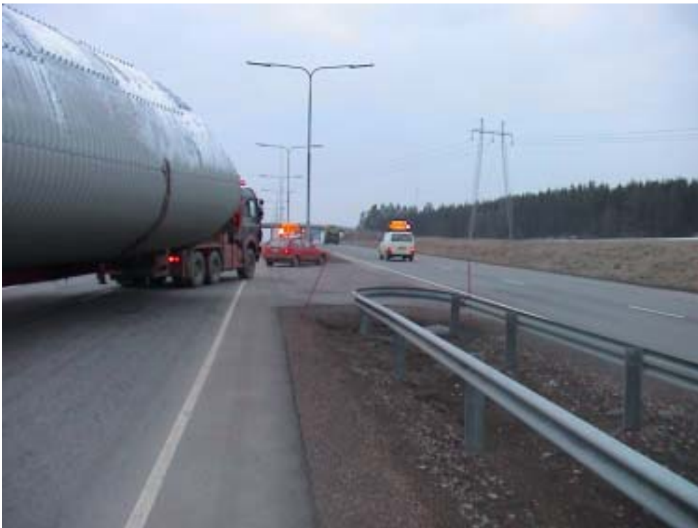
Kuva 5.15 Huoltoliittymän käyttö 2+2-ajorataisen tien ylittämiseen on aina erityisen vaarallista (Harri Vitikka).
