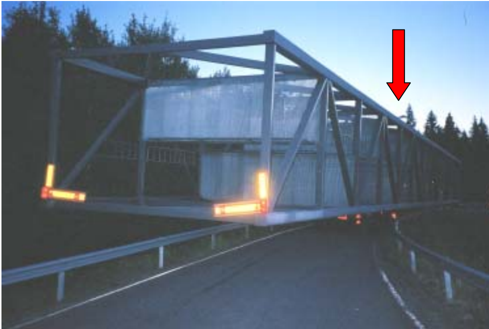
Kuva 5.25 Kapean rampin ulkokaarteessa oleviin valaisinpylväisiin juuttunut pitkä erikoiskuljetus (Vesa-Ville Kuitto).
