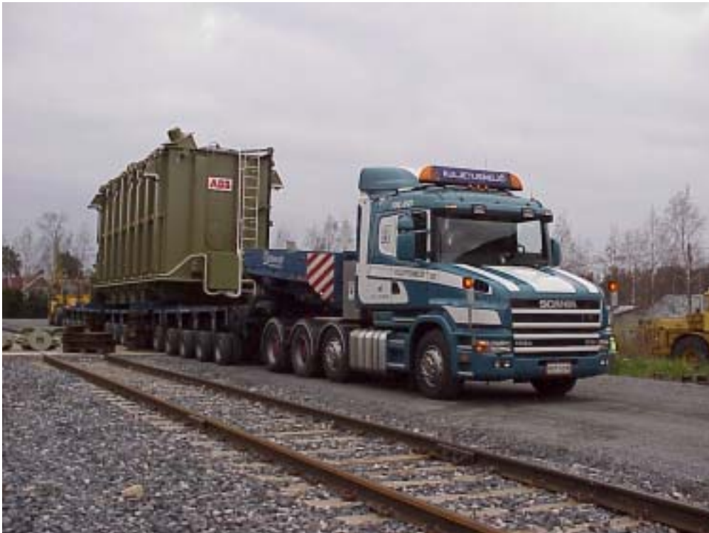
Kuva 3.2 Suurmuuntajan siirtokuormaus junasta autoon.
