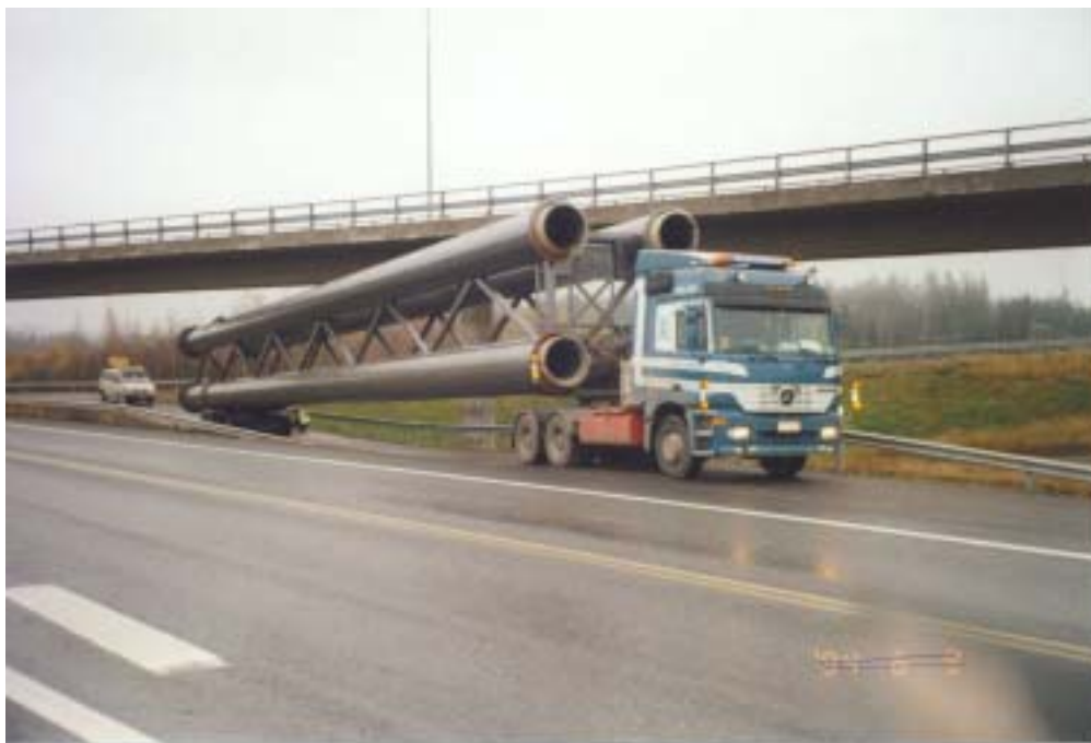
Kuva 5.14 Jyrkät tasaukset pienentävät erikoiskuljetusten kiertoreittien todellista alikulkukorkeutta (Kuljetusneliö Oy).
