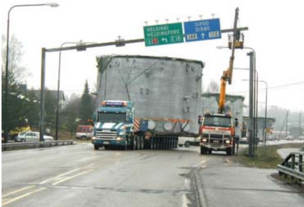
Kuva 5.18 Portaalin nosto rasittaa portaalin rakenteita sekä aiheuttaa lisäkustannuksia ja viivytyksiä (Kuljetusneliö Oy).
