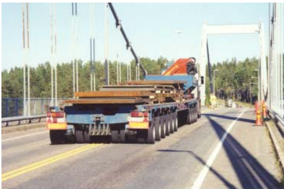
Kuva 5.19 Sääksmäen sillalla suoritettavalla koekuormituksella selvitetään sillan todellinen kantavuus.
