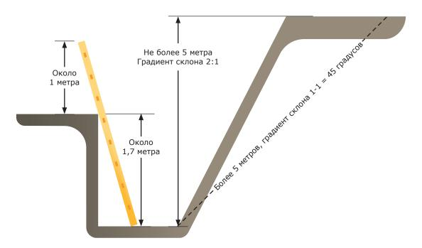
Стороны котлована должны быть либо укреплены, либо иметь определенный наклон. Наличие вертикальных сторон допускается только в случаях, когда глубина котлована не превышает 1,7 метра, при условии, что были проведены почвенно-геологические изыскания и не предполагается выполнять работы, стоя на коленях.
