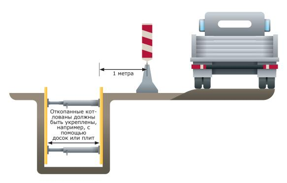
На строительной площадке должно обеспечиваться расстояние не менее 1 метра между участками движения транспорта и котлованом. Помимо этого, необходимо обеспечить, чтобы транспортные средства не заехали в котлован. Этого можно добиться, например, путем установки скоростных ограничений или применения ограждений.
