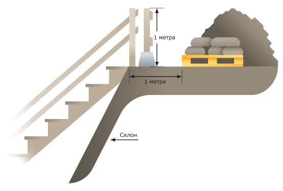
По всему периметру котлована установите ограждения высотой не менее 1 метра с перилами на уровне рук, колен и стоп. Обеспечьте, чтобы вблизи краев котлована не было инструментов, материалов или откопанного грунта на расстоянии не менее 1 метра.
