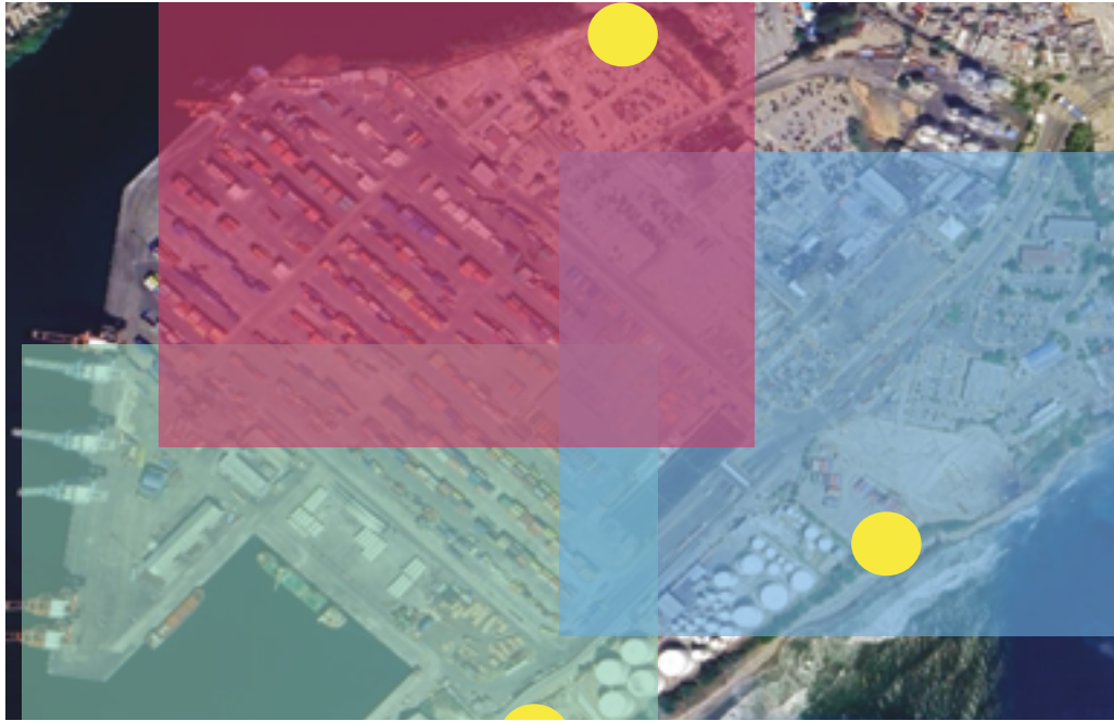
Figura II.18 Zonas de drenajes sanitarios propuestas, con PTAR
