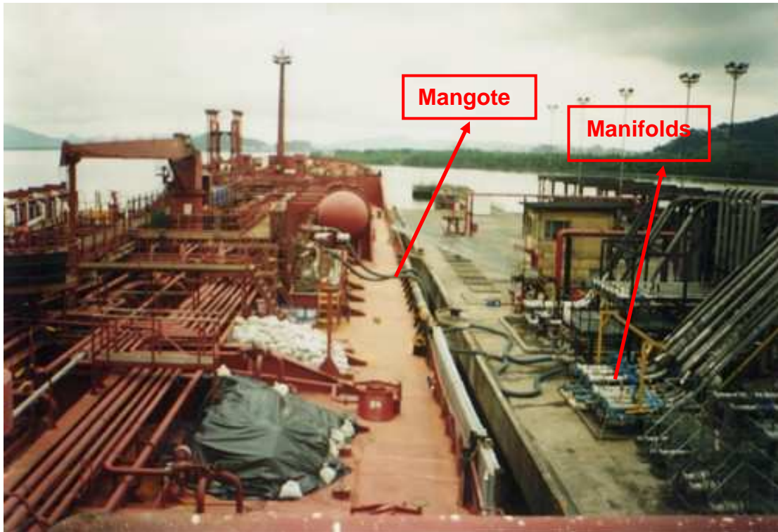
Figura 57 – Terminal de Granéis Líquidos – Porto de Santos – Sistema Equivalente ao do objeto de estudo – extraído de TRANSPETRO, 2012.
