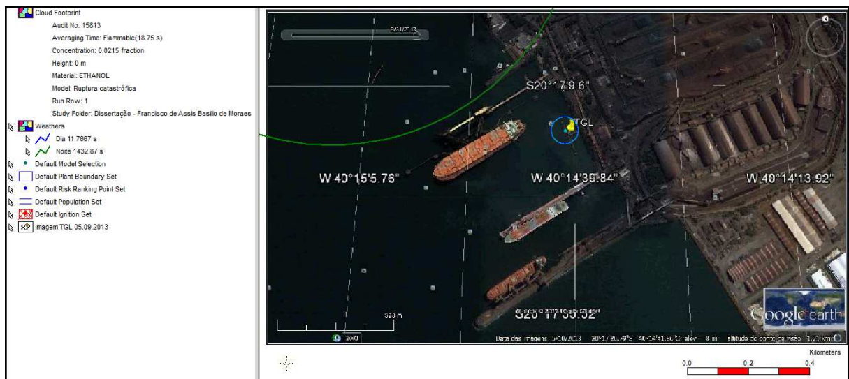
Figura 101 – Regiões de interesse para concentração de 50% do LFL – ajustado do PHAST RISK 6.5.4., DNV.
