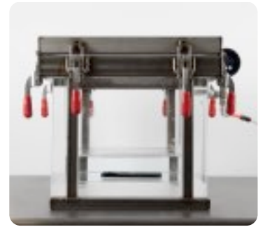
IPX7/8 の浸水保護テストでは、iPhone を加圧容器に沈め、水中で経験するような圧力をシミュレートしています。
