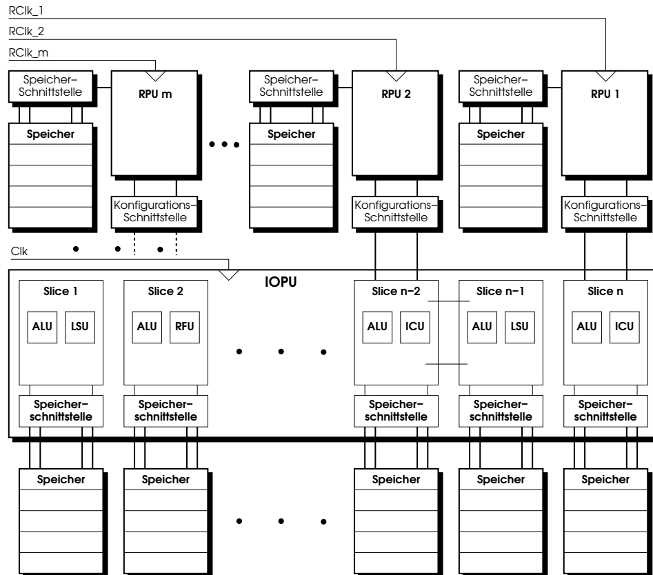
Abbildung 1: Globale Struktur der ReSArT Architekturvorlage
