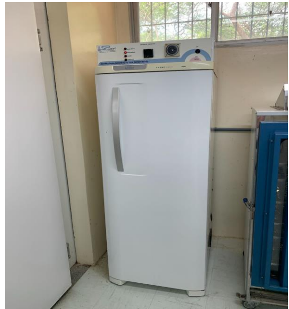
Figura 13 - Câmara para Germinação com Fotoperíodo, ideal para simular o dia e a noite.
