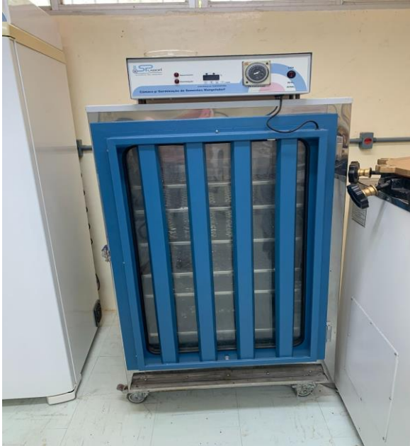
Figura 12 - Câmara para Germinação de Sementes Mangelsdorf, usada para testes de germinação e envelhecimento precoce de sementes.
