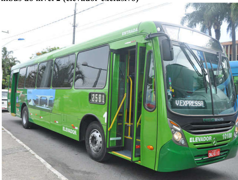
Figura 15 - ônibus do nível 2 da escala IAED com piso alto e elevador hidráulico instalado na porta traseira, operando em linha do transporte metropolitano da RMBH, lembrando que em todos os ônibus urbanos do sistema gerenciado pela Setop-MG o equipamento é sempre de exclusivo para cadeirantes (detalhes da fotografia: inscrição ELEVADOR na lateral esquerda e na parte frontal inferior esquerda do veículo; aplicação do SIA ao lado da porta traseira e na parte superior do vidro dianteiro do veículo). 62
