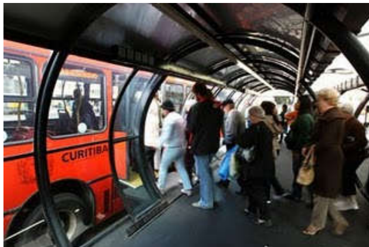
Figura 1 - ônibus do nível 10 da escala IAED com rampa veicular automática projetada para a plataforma de uma estação-tubo do sistema de transporte público de Curitiba permitindo o embarque/desembarque em nível de todos os passageiros, com autonomia e segurança, por todas as portas. 35
