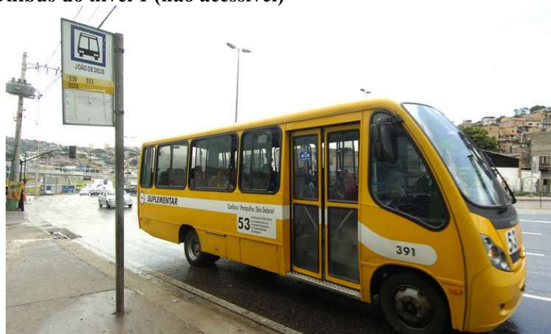
Figura 16 - ônibus do nível 1 da escala IAED com piso alto e sem elevador hidráulico da linha 53 do transporte suplementar de Belo Horizonte. 64
