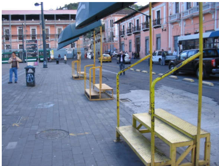
Figura 2C - escadas em praça de Quito para permitir o embarque/desembarque de ônibus do nível 10 da escala IAED com embarque/desembarque fora de estação de integração (detalhes da fotografia: as escadas estão chumbadas no piso da praça e são protegidas por sombrinhas). 38
