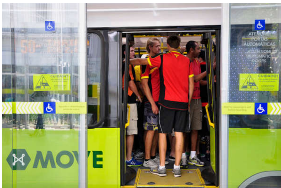
Figura 6 - ônibus do nível 8 da escala IAED em operação no BRT Move de Belo Horizonte com destaque para terceiro modelo de rampa veicular manual fechada instalada na porta central do veículo permitindo, quando basculada, o embarque/desembarque em nível dos passageiros na plataforma de uma estação de integração ou de transferência. 45
