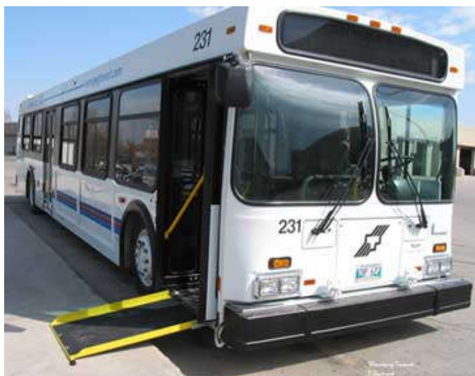
Figura 3A - ônibus do nível 9 da escala IAED com rampa veicular automática projetada para a calçada em Winnipeg/Canadá, permitindo o embarque/desembarque em nível de todos os passageiros, com autonomia e segurança, por uma porta. 40
