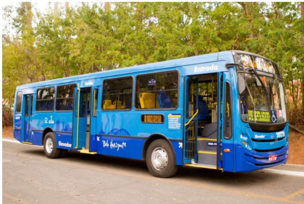
Figura 12 - ônibus do nível 3 da escala IAED com piso alto e elevador hidráulico instalado na porta central, lembrando que todos os ônibus fabricados a partir do ano 2009 que operam no sistema gerenciado pela BHTrans são equipados com elevador hidráulico e seu uso não é exclusivo para cadeirantes (detalhes da fotografia: inscrição ELEVADOR na lateral esquerda junto à porta central e na parte frontal inferior esquerda; aplicação do SIA na parte inferior do vidro dianteiro do veículo). 58
