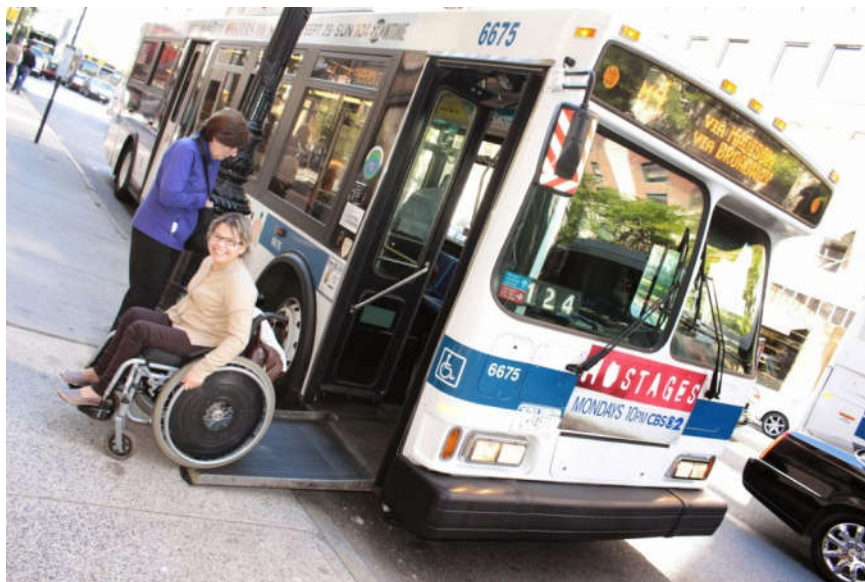
Figura 3B- ônibus do nível 9 da escala IAED com rampa veicular automática projetada para a calçada em Nova York/Estados Unidos, permitindo o embarque/desembarque em nível de todos os passageiros, com autonomia e segurança, por uma porta. 41
