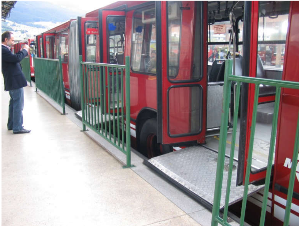
Figura 2B - ônibus do nível 10 da escala IAED, articulado, com rampas veiculares automáticas projetadas para a plataforma de uma estação de bairro em Quito/Equador permitindo o embarque/desembarque em nível de todos os passageiros, com autonomia e segurança, por todas as portas (detalhe da fotografia: como o ônibus é de piso alto, gradis protegem o passageiro do vão veículo/plataforma lateral às rampas). 37
