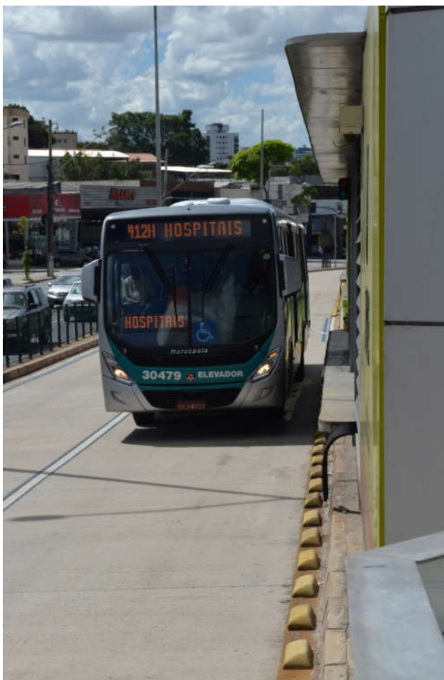
Figura 11 - ônibus do nível 4 da escala IAED com piso alto operando no BRT (misto) Move da RMBH, condicionando o embarque/desembarque dos passageiros com mobilidade reduzida, no percurso fora dos corredores de transporte, ao uso de elevador, lembrando que todos os veículos do BRT misto Move da RMBH possuem elevador hidráulico e seu uso é exclusivo para cadeirantes (detalhes da fotografia: inscrição da palavra ELEVADOR e aplicação do símbolo SIA na parte frontal inferior direita do veículo). 56
