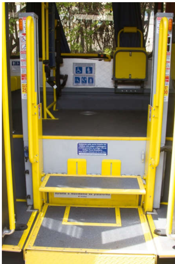
Figura 13 - detalhe de elevador hidráulico em ônibus do nível 3 da escala IAED com piso alto e equipamento instalado na porta central, lembrando que todos os ônibus fabricados a partir do ano 2009 que operam no sistema gerenciado pela BHTrans são equipados com elevador hidráulico e seu uso não é exclusivo para cadeirantes. 59
