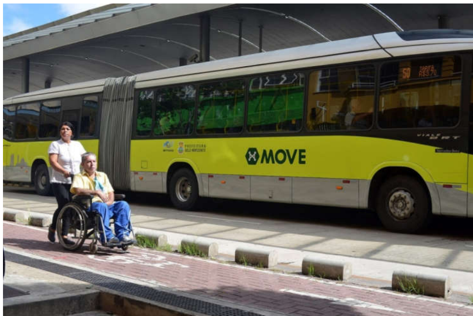
Figura 7 - ônibus articulado do nível 8 da escala IAED em operação na linha 50 (direta Estação Pampulha/Centro) do BRT Move de Belo Horizonte (detalhes da fotografia: do lado direito do ônibus não há portas para embarque/desembarque de passageiros e a única porta existente desse lado do veículo é para acesso exclusivo do operador; cadeirante e seu acompanhante circulam na ciclovia). 46
