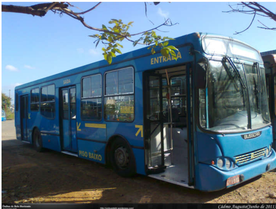
Figura 8 - ônibus do nível 6 da escala IAED com piso baixo dianteiro/central sem rampa veicular em linha do transporte convencional de Belo Horizonte, permitindo o embarque/desembarque em nível de todos os passageiros com autonomia e segurança se o motorista alinhar completamente o veículo com a calçada (detalhes da fotografia: inscrição PISO BAIXO na dianteira e na lateral da carroceria). 50
