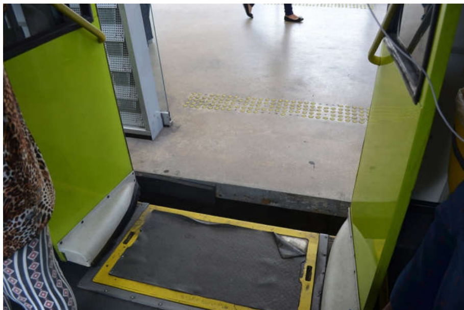
Figura 5 - ônibus do nível 8 da escala IAED em operação no BRT Move de Belo Horizonte com destaque para segundo modelo de rampa veicular manual fechada instalada na porta central do veículo permitindo, quando basculada, o embarque/desembarque em nível dos passageiros na plataforma de uma estação de integração ou de transferência (detalhes da fotografia: rampa em mal estado de conservação; indesejados vão horizontal e diferença de altura entre veículo/plataforma;). 44
