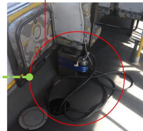
Medidor de fluxo de diesel
