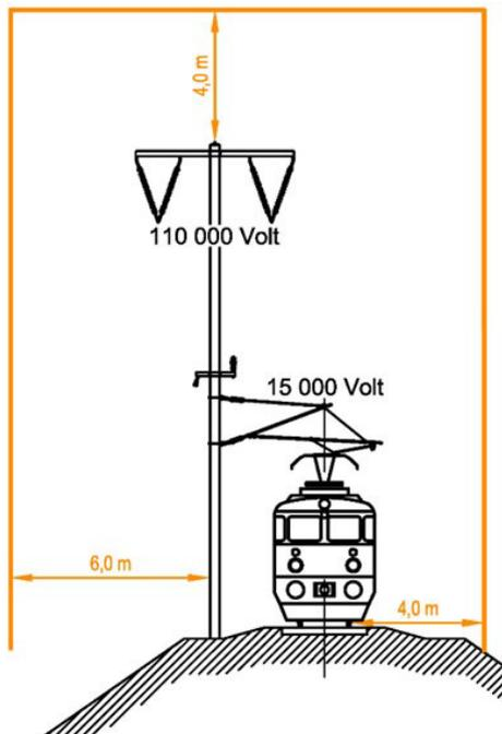
Im Bereich außerhalb von 6,0 m (hinter dem Oberleitungsmast) bzw. 4,0 m Bereiches gemäß Skizzierung (in orangefarbener Farbe dargestellt) sind keine elektrotechnischen Schutzmaßnahmen erforderlich. **Erfordern Ihre Tätigkeiten eine Unterschreitung des Bereiches von 6,0 Meter bzw. 4,0 Meter so ist dies exakt in den Einreichunterlagen zur Erlangung der eisenbahnrechtlichen Ausnahmegenehmigung anzuführen und einzuzeichnen.**
