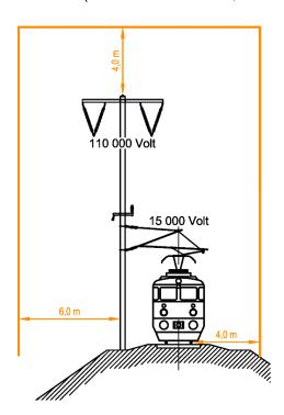
Im Bereich außerhalb von 4,0 Meter von der äußersten Schiene oder 6,0 Meter von der Oberleitungsmast - Hinterkante sind keine elektrotechnischen Schutzmaßnahmen erforderlich.
