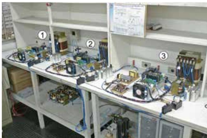
FIGURA 63 — Foto do protótipo dos três inversores em paralelo.
