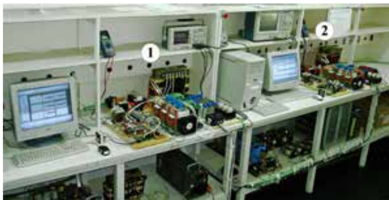
FIGURA 98 — Foto dos dois inversores em paralelo.
