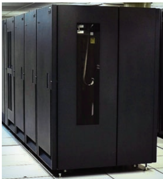
Robótica: Cerca de 3 mil fitas para cópias e recuperação de arquivos são acionadas através de um braço mecânico.
