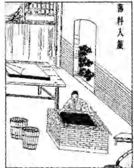
ייצור ניר ביד (ניצור מיני, המסחר שקיימת הנפה מן האמבט)
