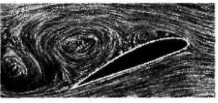
ציור 1. זרימה סביב כנף לנף מפוצצת: שובל בעורף הכנף; למטה: מערבלים בעורף הכנף
