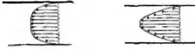
ציור 2. המוריות כורסת נזול ביצור מייזי: הלוקת המוריות בורומה שכבתית; משמאל: הלוקת המוריות המפוצצות בורומה מפרפרת
