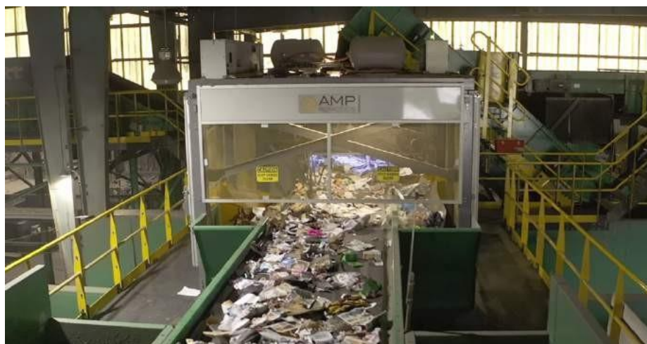
Gambar 4.3 Proses Pemilahan Sampah dengan Lengan Robot Otomatis
